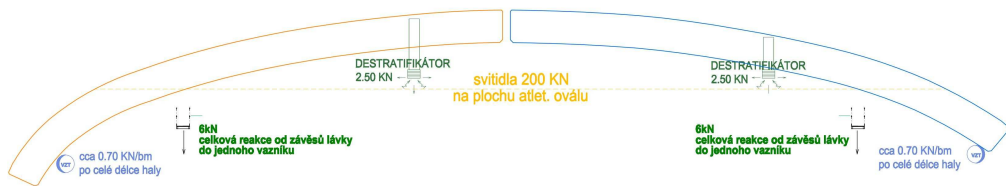
Obr. 2 Schémata zatížení konstrukce trojkloubového nosníku
